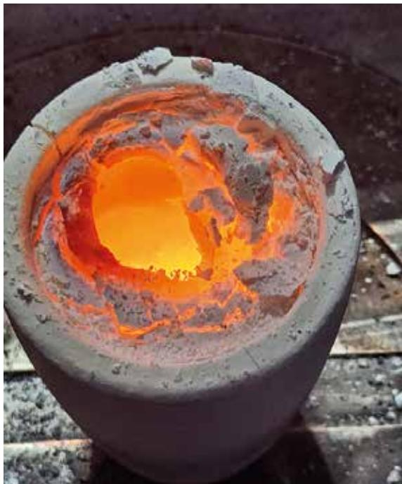
Muestra de silicato de zirconio instantes después de su tratamiento con un haz de energía solar concentrada.
