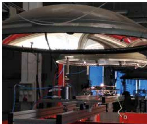
Imagen de un horno solar empleado en los experimentos de obtención de zirconia por descomposición térmica de silicato de zirconio.
