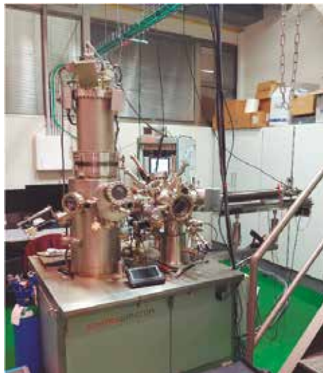
Microscopio Criogénico de Sonda de Barrido.
