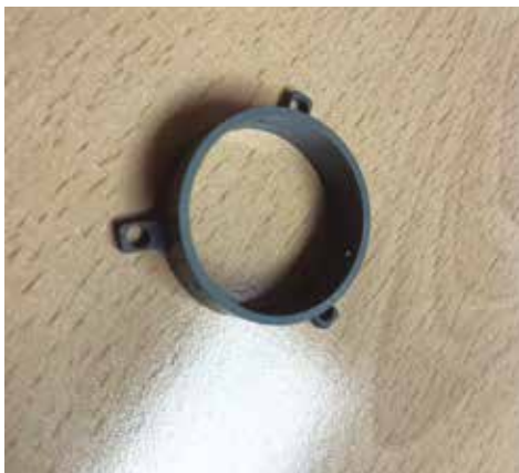
Componente cerámico ultraestable para estructuras de telescopios espaciales
