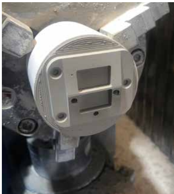
Mecanizado en verde de estructura ultraestable de LAS-nSiC Green machining of ultrastable LAS-nSiC structure
