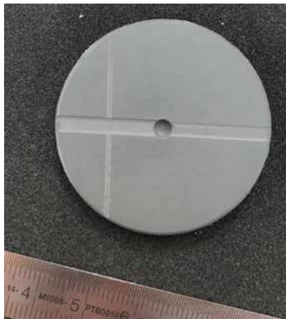
Mecanizado de composite LAS-nSiC sinterizado Machining of sintered LAS-nSiC composite
